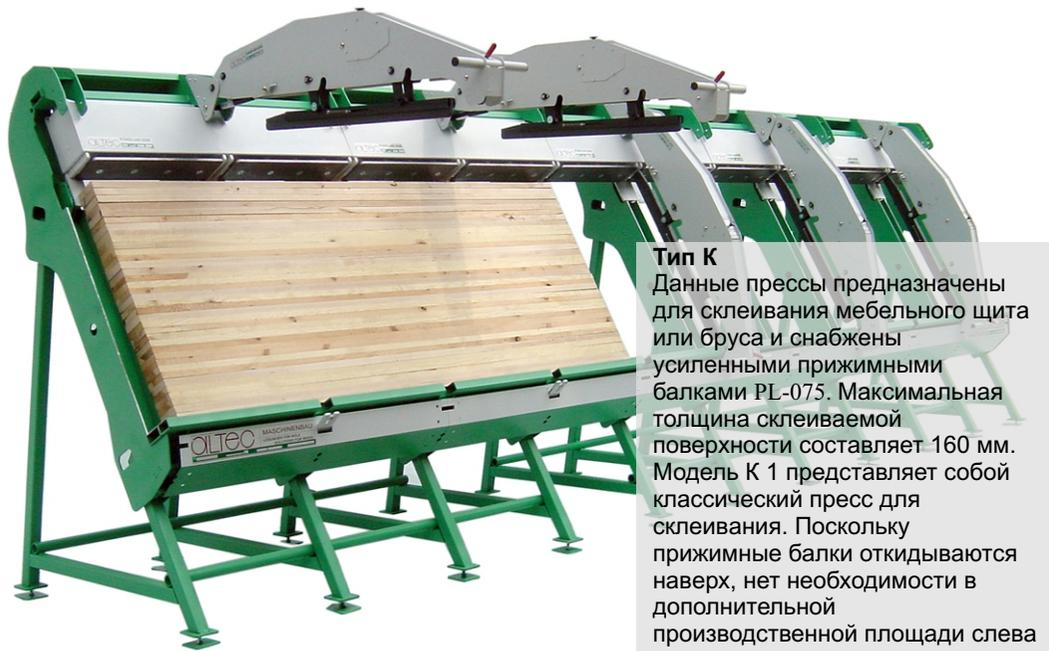
Пресс для склеивания К1-075, высота склеивания: 80-160 мм, длина склеивания: 2600-6500 мм; высота загрузки: 1000 мм.
